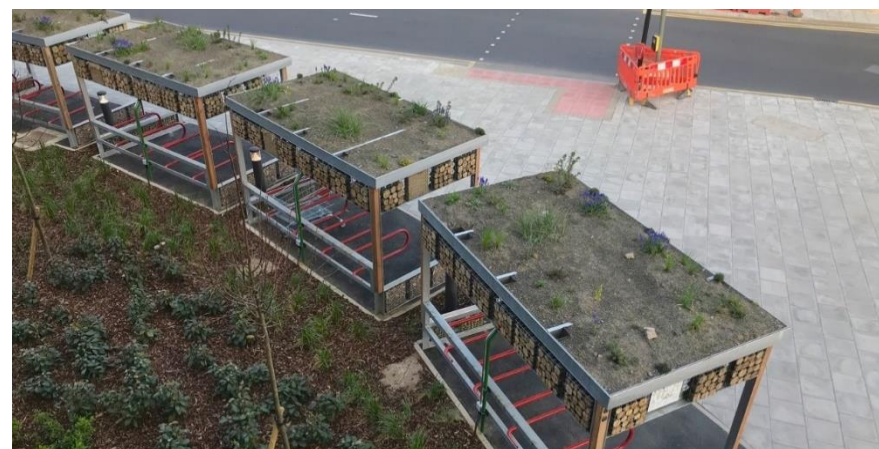
Figuur 65 IKEA Greenwich fietsenstallingen. Bron: livingroofs.org
